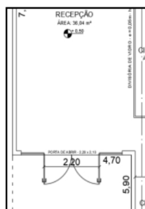
Imagem 02: Instalação Nova porta de abrir
